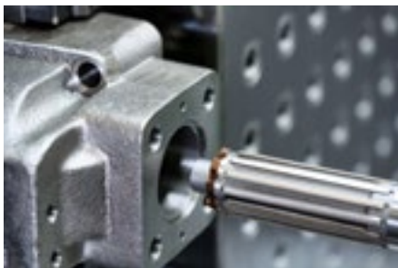
Pièce: Bloc de vannes (fonte nodulaire) Outil: RH reamhone
