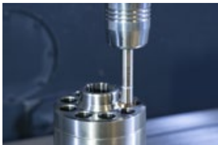
Pièce: Pompe à pistons (acier) Outil: RX medium
