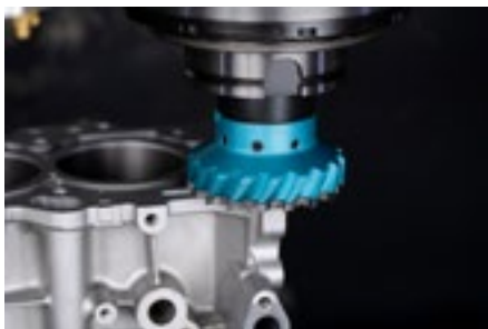
Pièce: Bloc-moteur (aluminium) Outil: MX diamond
